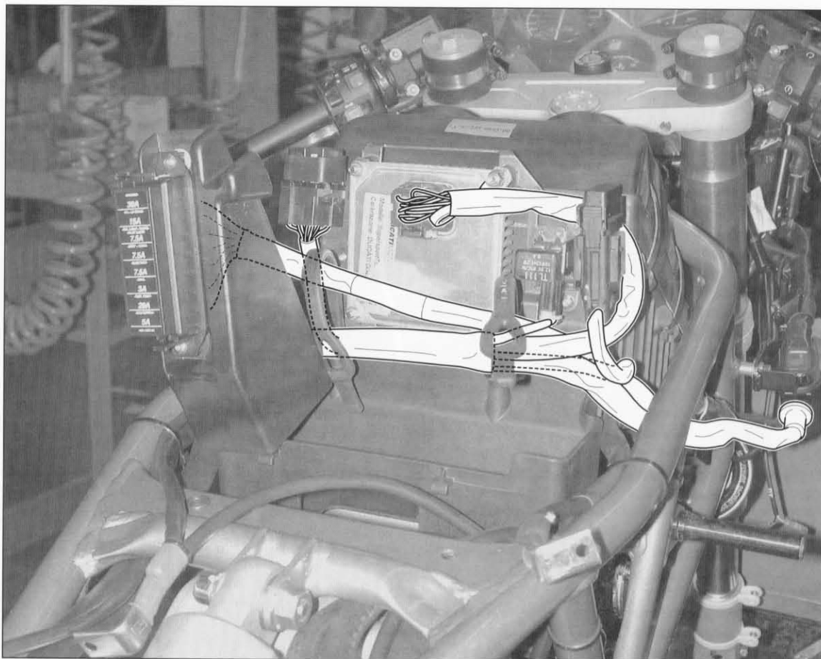
Posizionamento tubi serbatoio sonda livello carburante
